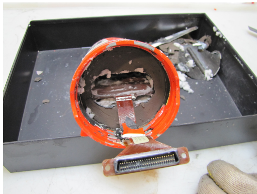
Figure 22 : cartes mémoire du CVR après retrait des protections thermiques
