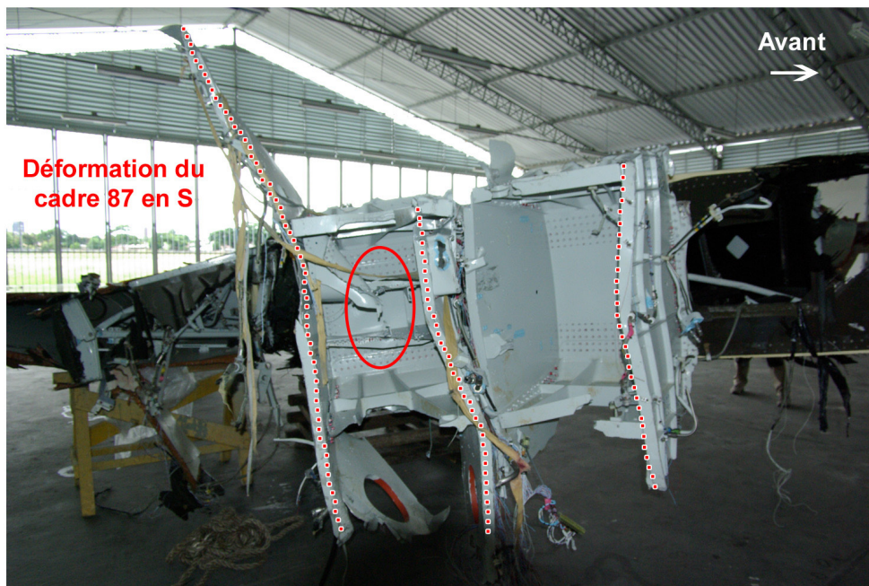
Figure 50 : cadres 84 à 87 : déformation en S du cadre 87, enfoncement des cadres 84 et 85 vers l'arrière, rupture des supports de la vis de réglage du plan horizontal situés entre les cadres 86 et 87 (cercle rouge)
