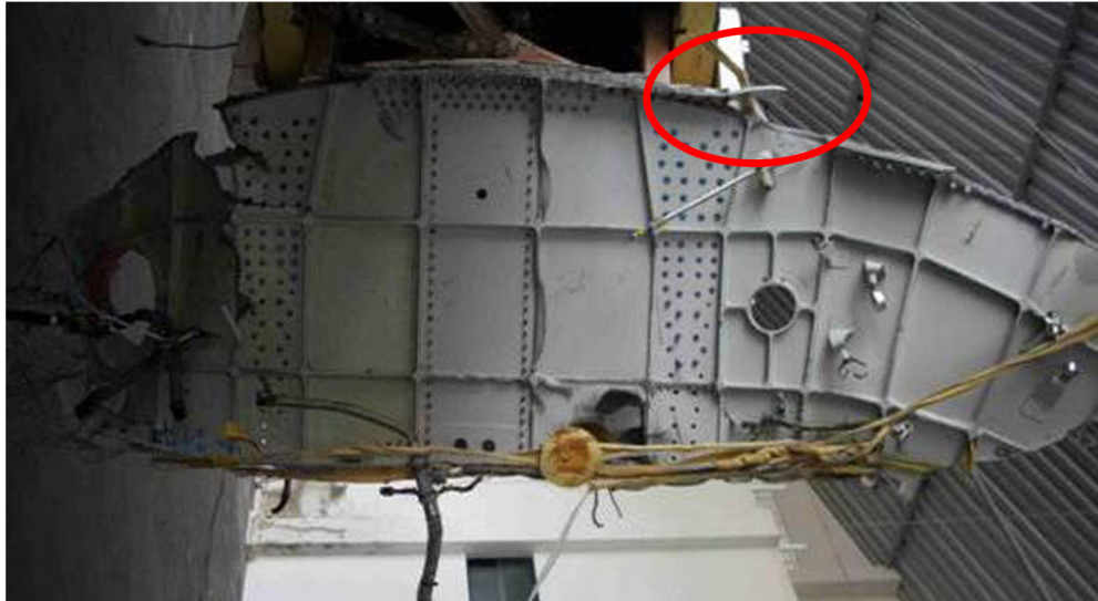
Figure 48 : cadre 87 : cisaillement du cadre et de la peau de fuselage au droit du cadre
