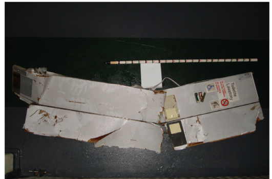
Figure 37 : renforts métalliques d'une porte
