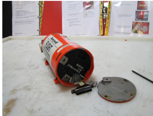
Figure 21 : ouverture du CSMU du CVR
