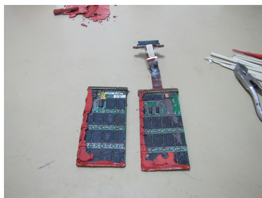
Figure 23 : cartes mémoire du CVR avant nettoyage
