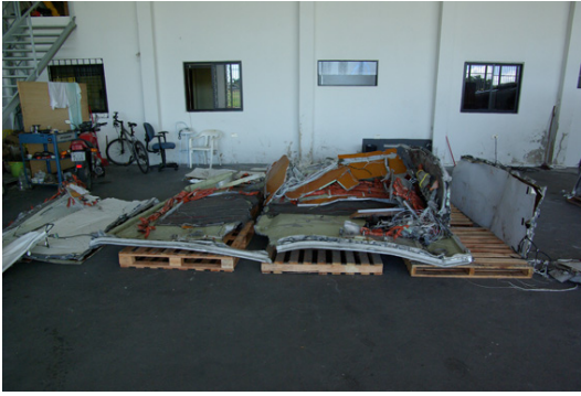
Figure 38 : plancher du module de repos PNC : déformation du bas vers le haut
