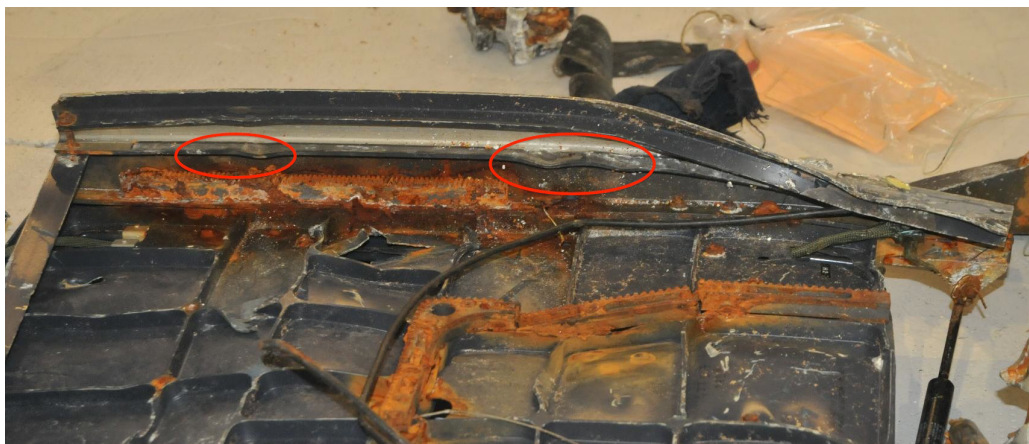
Figure 80 : traces des galets sur le rail de guidage
