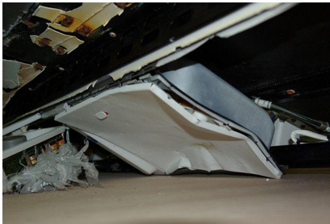
Figure 40 : container à oxygène passager retrouvé fermé : les déformations du couvercle et de la boîte sont concordantes
