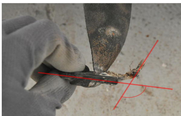
Figure 84 : déformation de l'attache de la ceinture sous-cutale
