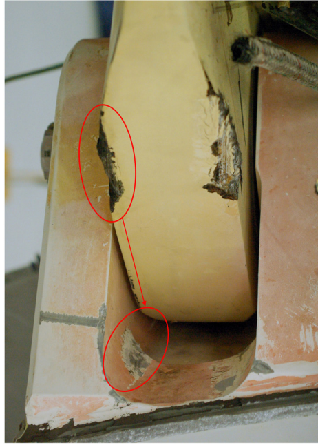
Figure 52 : vue de l'arrière de la chape arrière gauche : traces montrant le basculement des cadres 86 et 87 vers l'arrière
