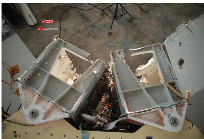
Figure 51 : fixations centrale et arrière de la dérive
