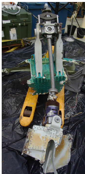
Figure 61 : vis de réglage du PHR après sa remontée sur le bateau
